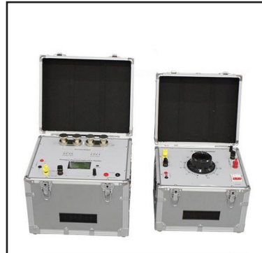
2000 Amper Akım Kaynağı
